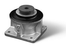
El soporte AMC-Mecanocaucho® cono con Base de Fijación, trabaja el elastómero a compresión cizalladura. Está constituido por una armadura exterior metálica de alta resistencia y de una armadura cónica interna que incorpora un nivelador para la correcta alineación del conjunto suspendido.
