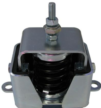
Estos soportes están fabricados con sistemas de anclaje mecánico que permiten asegurar su unidad en aplicaciones estáticas y ofrecer una gran fiabilidad para el aislamiento de vibraciones de baja frecuencia. Con el objeto de mejorar su comportamiento en aplicaciones sísmicas el departamento técnico de AMC-MECANOCAUCHO ha diseñado una nueva arquitectura interna que permite resistir a dichos entornos.
